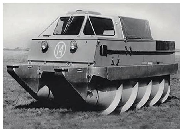
Шнекороторный вездеход предназначен для эвакуации космонавтов, приземлившихся в труднодоступных местах, – там, где бессильны гусеничные и колёсные вездеходы. Машина была выпущена ограниченным тиражом в период с 1980 по 1991 г. и до сих пор стоит на вооружении Федерального управления авиационно-космического поиска при Минобороны РФ.
